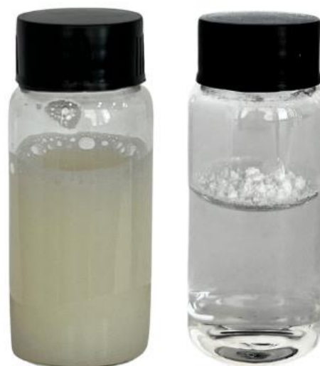
Figura 2. Foto comparativa da avaliação da solubilidade em meio aquoso da nVitamin D3 Nutrition (esquerda) e Vitamina D3 convencional (forma não-nanoencapsulada em cristais) (direita).
